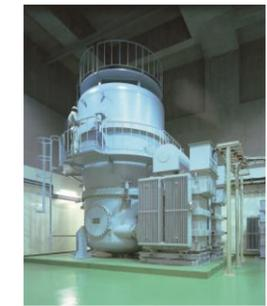
電子線照射装置(加速器本体)
