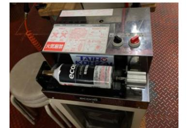
非有機溶剤系のスプレー式洗浄剤及び充填装置
