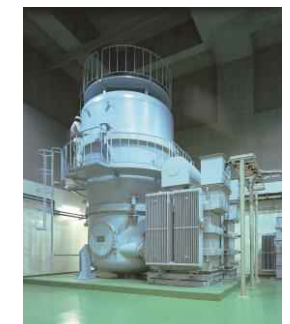
電子線照射装置(加速器本体)
